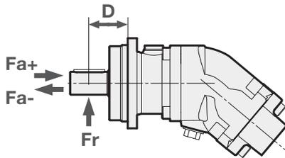
Оптимальное направление действия силы радиальной нагрузки
