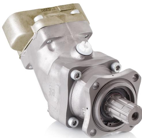
**SCM 012-130 DIN – это серия аксиально-поршневых гидромоторов для мобильных гидравлических систем. SCM 012-130 DIN – это гидромотор с наклонным блоком цилиндров со сферическими головками поршней.**
